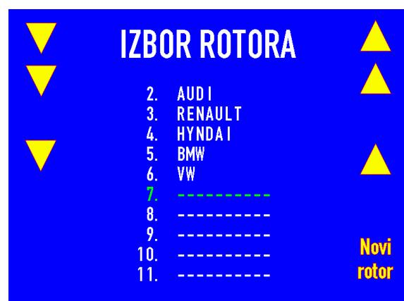
Klikom na ikonu "Briši rotor", briše se izabrani rotor iz liste. Obrisani rotor ne može više da se povrati, već je neophodno da se ponovo unesu podaci i uradi kalibracija.
